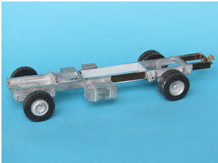
Chassis trekker van Miho kit verlengd met kunststof en messing profiel
